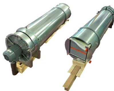
Soufflerie utilisée pour la définition de la porosité du radiateur
