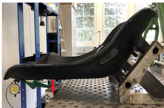
Déformation mesurée : 1,19mm
