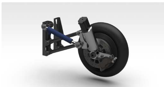
Fahrwerksbaugruppe mit elektrischer Lenkung
