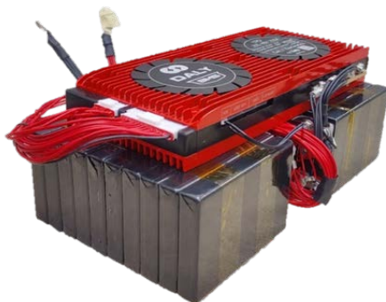
Entwickelte und validierte 48 V LTO-Batterie
