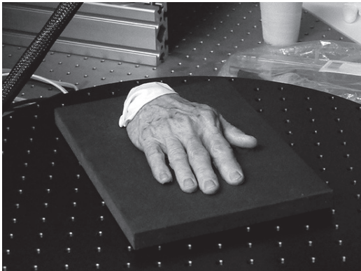
// Moulage beim Scannen: Eine Versuchs-Moulage auf dem Drehteller des 3D-Scanners im Institut für Drucktechnologie der BFH-TI. (Bild: Sebastian Dobrusskin)
