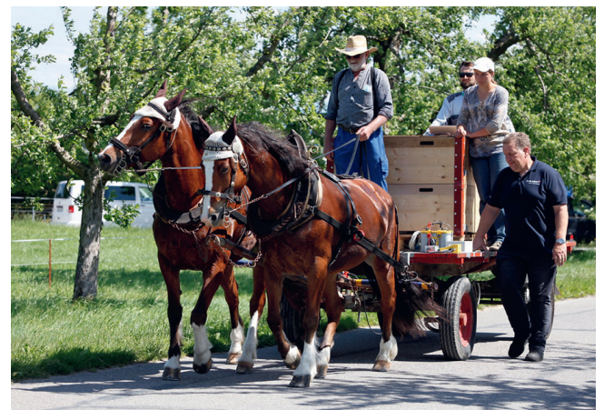
Abb. 1 Freibergergespann 1/2 am gebremsten Wagen mit einer Zugkraftleistung von 2600N. Über dem Vorderrad sichtbar die Apparatur zur simultanen Zugkraftmessung; auf dem Wagen die Computerüberwachung. | French mountain horse carriage 1/2 on the braked carriage with a tractive effort of 2600 N. Visible above the front wheel is the equipment for simultaneous tractive force measurement, and on the wagon is the computer monitoring system.
