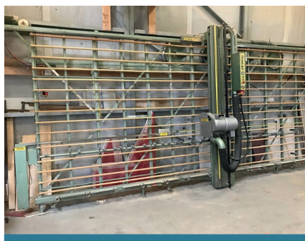
Bestehende Plattensäge (eigene Aufnahme)
