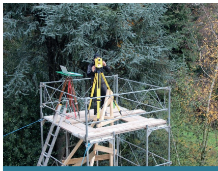
Messstation auf einem 8m hohen Messturm
