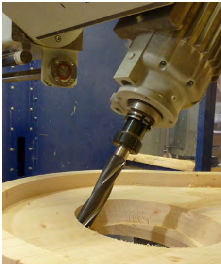
CNC-Bearbeitung einer Zange
