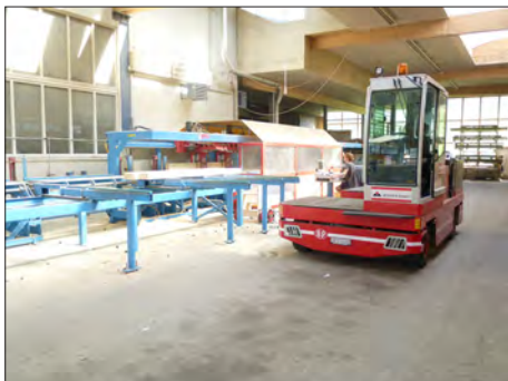
Abbandanlage und Elektrostapler
