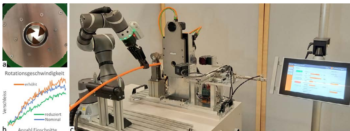
Abbildung 1: a) Messer der Schneideinheit b) Grafik des Verschleisses bei unterschiedlichen Rotationsgeschwindigkeiten c) automatisierter Testaufbau mit Cobot, Rotationseinheit und Keyence Messgerät
