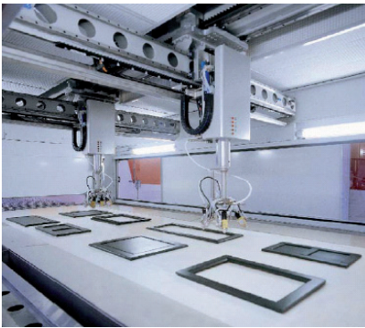
Spritzroboter (i-botic) Cefla Finishing
