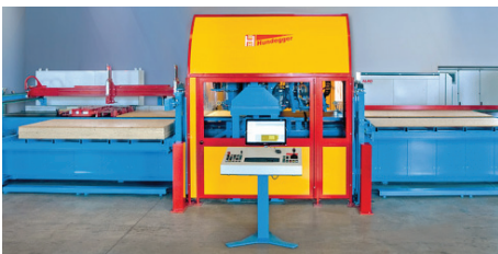
Evaluation einer CNC Abbundanlage Plattenbearbeitungsautomat Speed-Panel-Maschine SPM
