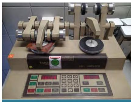
Prüfung der Abriebbeständigkeit
