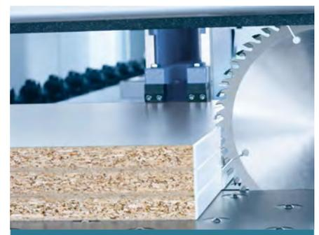
Sägelinie einer Zuschnittanlage
