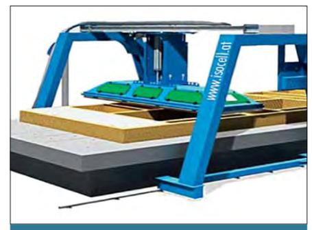
Einblasplatte mit Brückenlösung von Isocell
