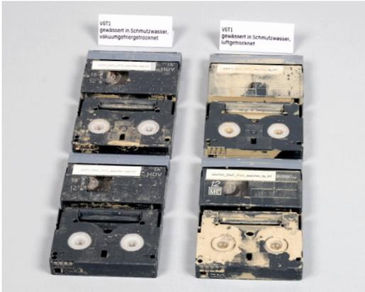
// Dokumentation der Probekörper nach der Vakuumgefriergetrocknung und der Lufttrocknung: Bei der Lufttrocknung neigt der Schmutz an den exponierten Stellen eher zu einer Schichtenbildung, bei der Vakuumgefriergetrocknung fallen die Schlammreste von den Kassettenhüllen tendenziell leichter ab.
