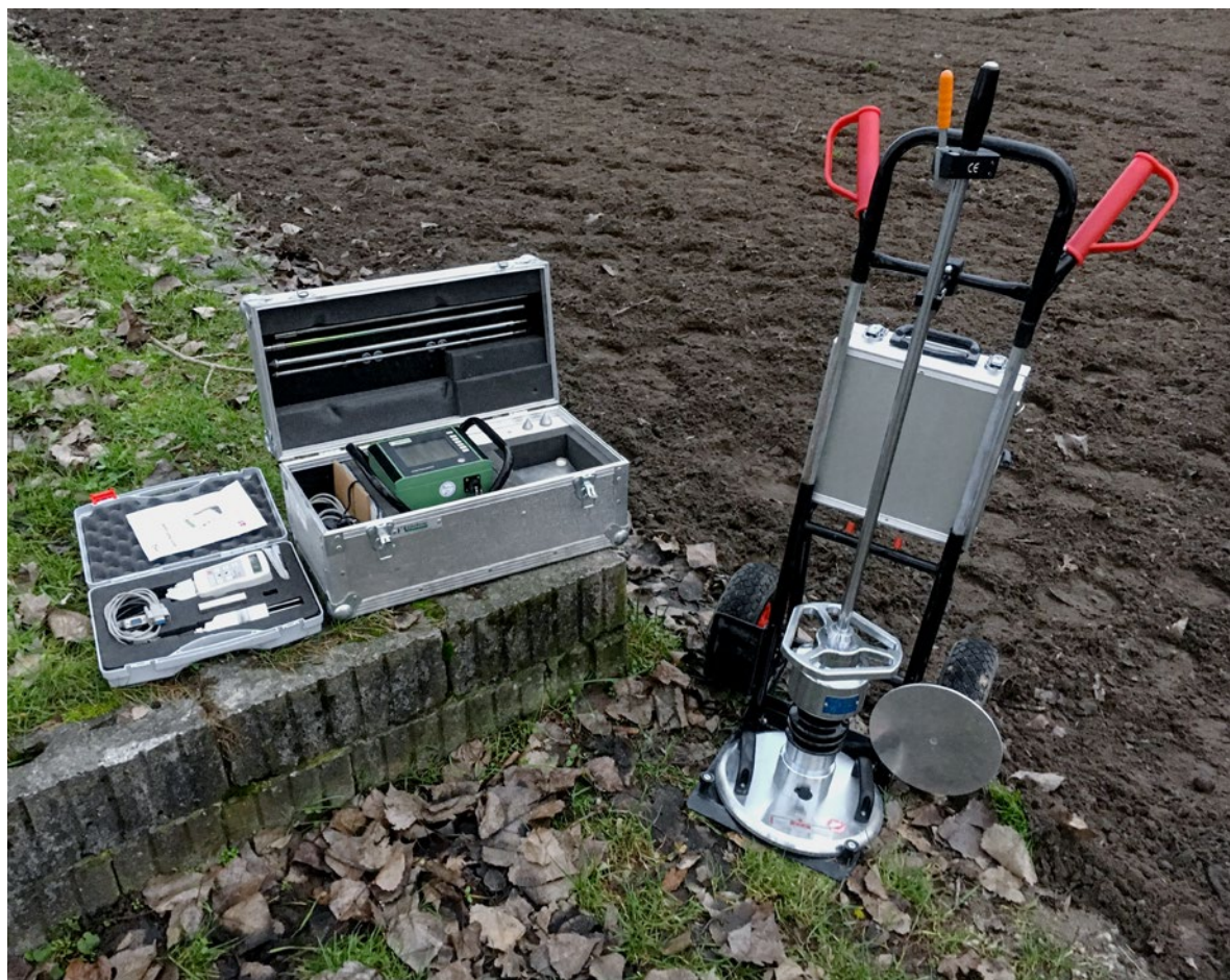
Image 2: Sonde hygrométrique (à gauche) et masse tombante légère (à droite) ainsi que la carrière à analyser en arrière-plan
