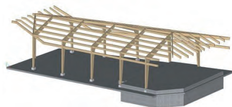
Abbildung 4, Gewähltes Tragwerk mit Dreigelenkrahmen
