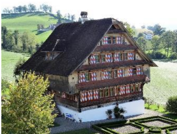
Abb. 336, 337: Bauernhaus Rüt matt, Ruswil, 1758. Links im EG der Giebfassade hat es Fallläden, in den Obergeschossen horizontale Schiebeläden. Rechts ursprüngliche Schiebeläden auf der Traufseite, welche geschützt unter der Laube sind.
