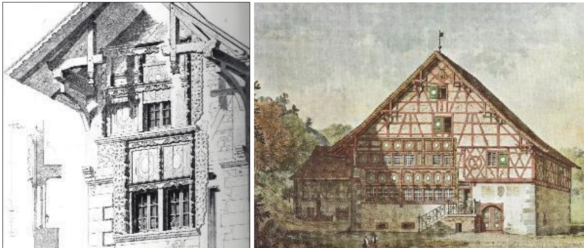
Abb. 311, 312: Manneberger Mühle, 1675, Effretikon, links Detail mit Vertikalschnitt von Fallläden, rechts Ansicht Hauptfassade.
