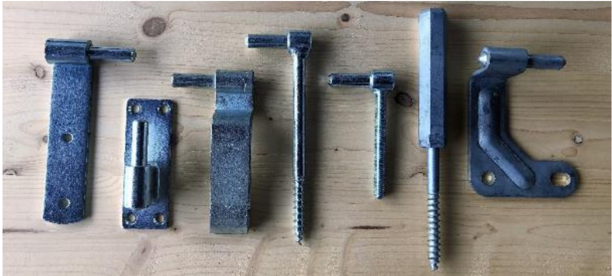
Abb. 100: Diverse Kloben, die heute verwendet werden, Benennung von links nach rechts: Futterkloben, Aufschraubkloben, Mauerkloben zum Einmörteln, Kloben mit Holzgewinde, Kloben mit metrischem Gewinde zum Dübeln, Beschlägeträger und Kloben für Aussenisolation.
