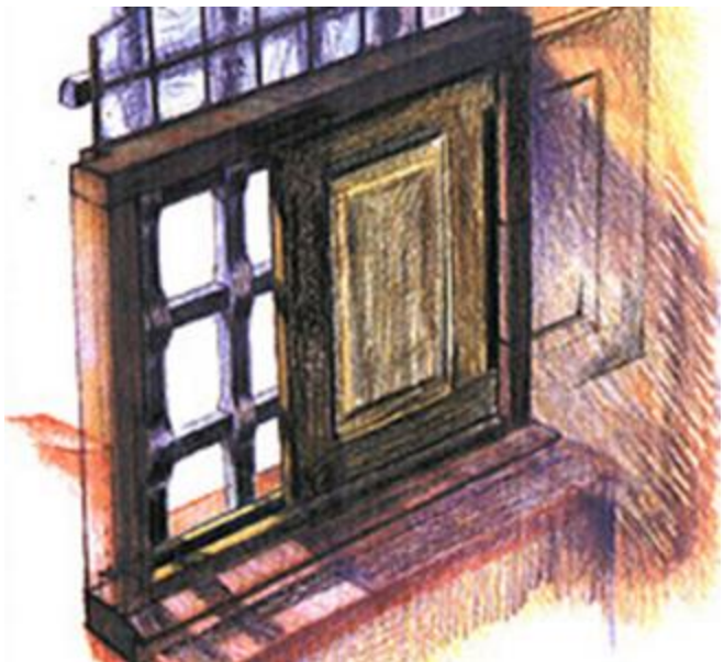
Abb. 164, 165: Baltersan Castle, Schottland, 1584. Foto links Schlitz von Tasche, in welcher die Läden versenkt wurden. Rechts Skizze der möglichen Situation.
