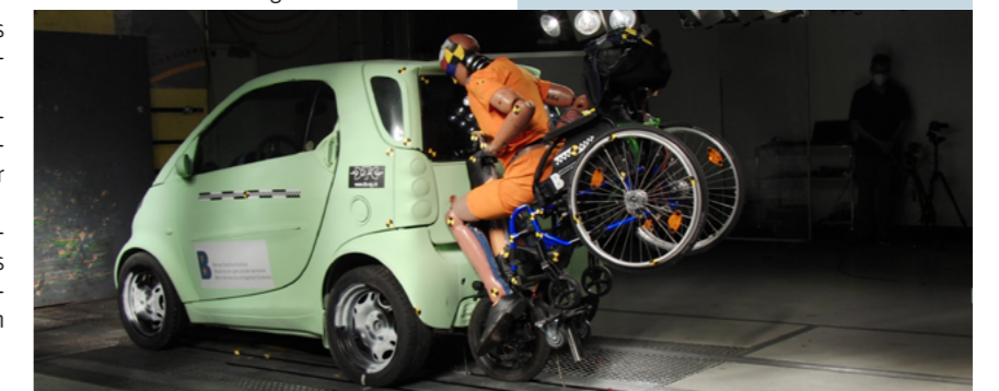
▼ Abbildung 4 – Crashtest bei 20 km/h: Aufprall auf das Heck eines stehenden Fahrzeugs.
