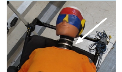
▲ Abbildung 3 – Endposition des Crashtest-Dummies nach einem Aufprall mit einem Rollstuhl ohne Kopfstütze.
