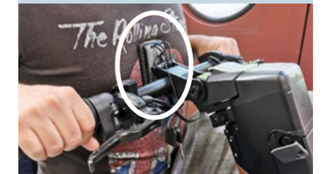
▲ Abbildung 2 – Display am Lenker des e-pilot, das bei einem Aufprall mit dem Oberkörper in Berührung kommen kann.
