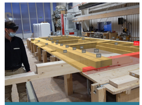
Ansicht des Hologramms durch die HoloLens II
