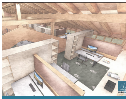
Surélévation du toit au-dessus des fermes actuelles
