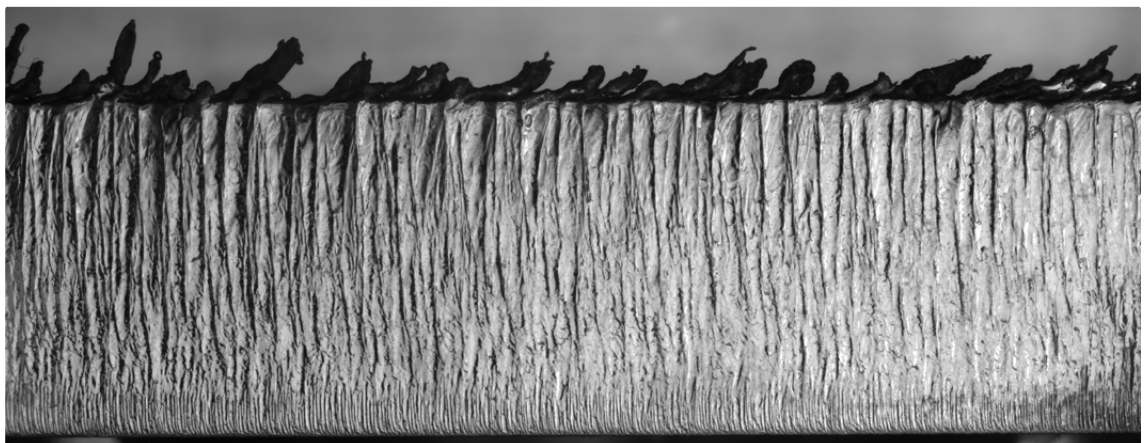
Schnittflächenbild von Lasergeschnittenem Teil
