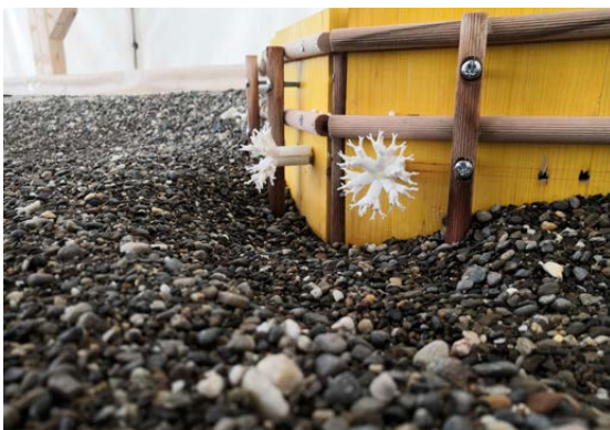
Versuchsaufbau, Kolkbildung unterhalb der Wurzelteller
