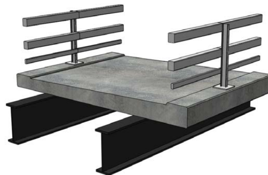
Isometrie eines Fahrbahnelements aus Stahlbeton
