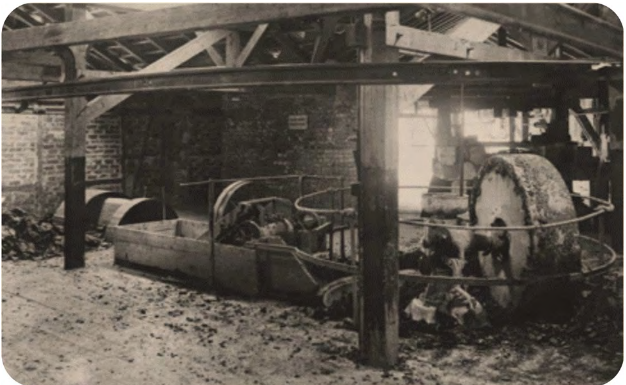
Kollergang um 1920, wo die Seilbahn jeweils das Material aus der Grube abgeladen» hat. aus www.aqz.ch – Vom Ziegelwerk zum Wohnquartier
