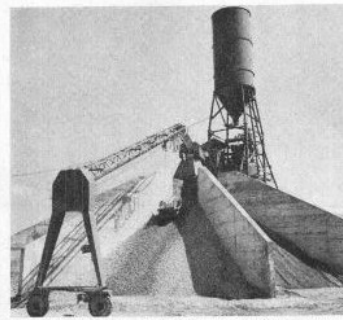
Zwangsmischer Raco-von Roll 750 I, Automatik-Schrapper Zykos, Pfister-Kieswaage mit Fernanzeige, Frischbeton-Vorsilo 3,5 m 3 für Lastwagenbeschickung (Gravière de Courroux SA, Courroux)
