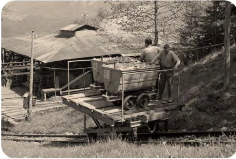
Die beladenen Loren auf ihrer Fahrt mit der Standseilbahn zur Seilbahn-Bergstation. Aus bebrail.ch – Foto Heinz Bircher, 22.05.1986
