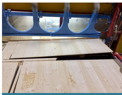
Eine Platte verkeilt beim Zuschnitt auf der SPM
