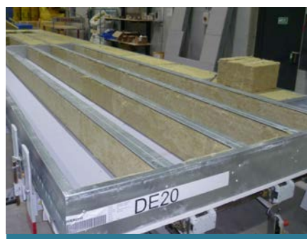
Hier werden die Cocoon-Elemente ausgedämmt
