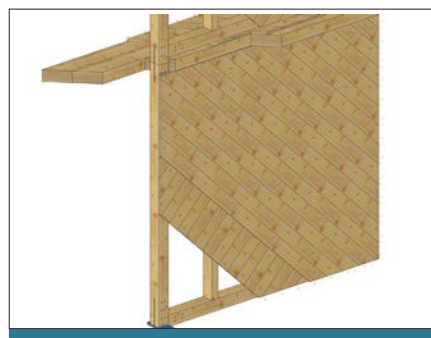
Aussteifungsscheibe mit Diagonalschalung
