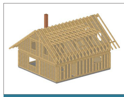
Représentation en 3D d'une villa en ossature bois
