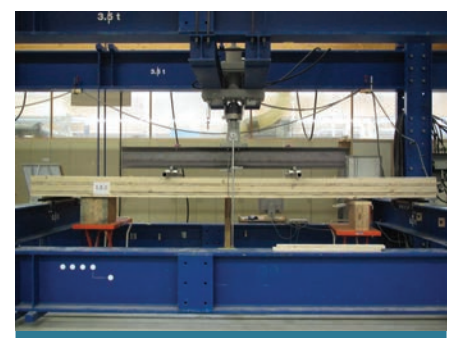
Prüfelement beim Biegeversuch im Prüfrahmen
