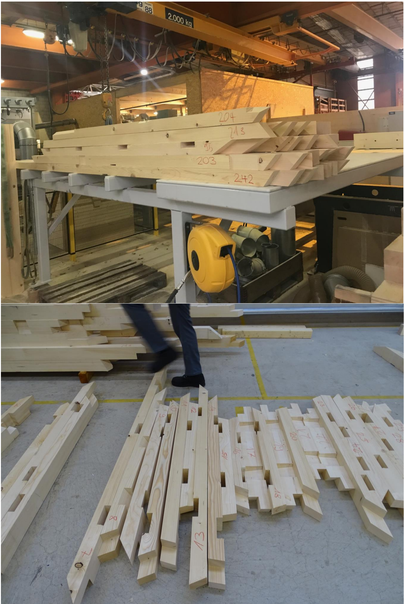
Der komplexe Abbund wurde auf einer TW-Agil (Schweizer CNC-Abbundcenter) bei der Firma Roth AG gemacht.
