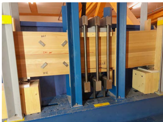
Abb. 1: Schubprüfung mit mittig angeordneter Blockfuge
