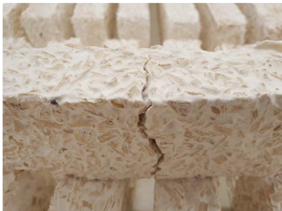
Prüfkörper aus Pilzmyzel-gebundenen Buchenspäne nach der Biegeprüfung.
