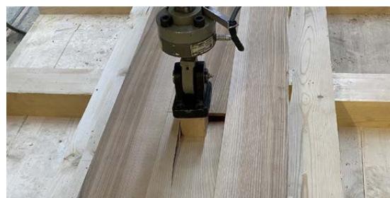
Bruchversagen bei Stirnstossprüfung
