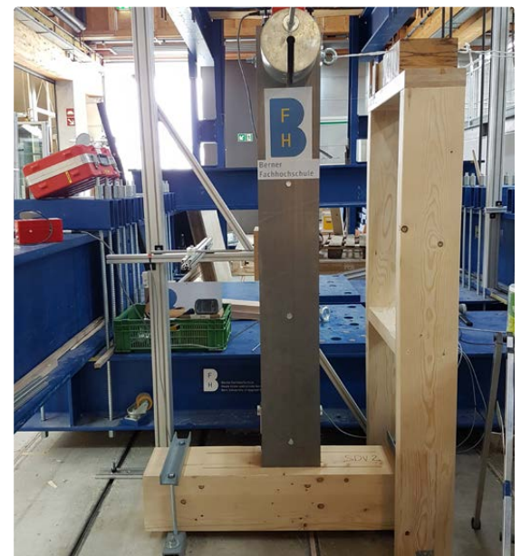
Ausschwingversuch an einem Prüfkörper mit Stabdübelverbindung.
