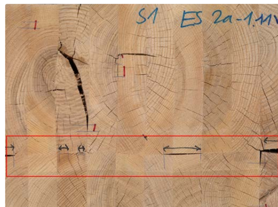
Abb. 2: Ausschnitt Delaminierungsprüfkörper mit nicht optimaler Verklebungsqualität
