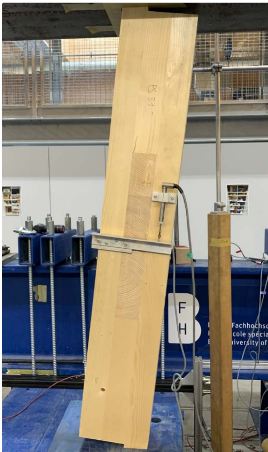
Versuchsaufbau zur Festigkeits- und Steifigkeitsermittlung
