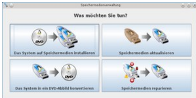
Abbildung 7: Mit der Speichermedienverwaltung lässt sich das ganze System klonen oder reparieren. Im Bild rechts werden in einem Arbeitsgang 9 identische Sticks erstellt. Diese werden anschliessend, bevor sie in den Thinclients als Boot- und Speichermedium dienen, auf HDs von Schülerlaptops gespielt.
