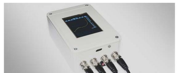
Prototyp des portablen Batterie-Testers
