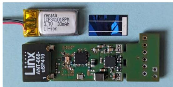
Bestückter Prototyp mit Akku und PV-Zelle
