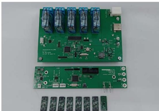
Entwickelte Hardware von oben nach unten: Hauptmodul, Messmodul und Temperaturmessmodule
