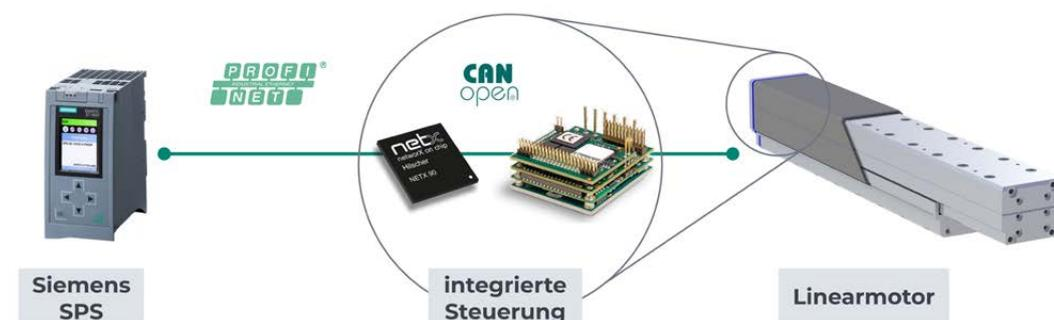
Konzeptbild des finalen Produktes. Die im Linearmotor integrierte Steuerung kann von einer Siemens SPS angesteuert werden.
