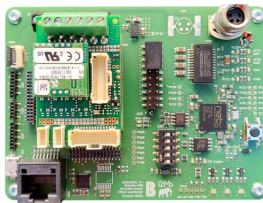
Prototyp-PCB der Steuerung. Links der Motorcontroller, rechts der netX Chip mit Supportkomponenten.
