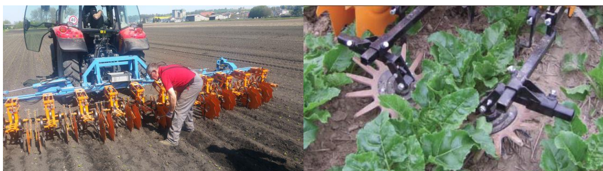
Abb.1 12-reihiges Hackgerät von Schmotzer (links) mit Fingerhackelementen für die Unkrautbekämpfung in den Reihen (rechts).
