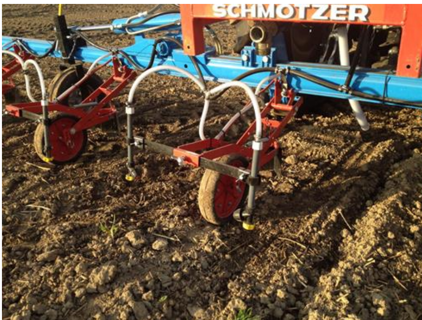
Abb. 2b Bandspritzgerät mit einer Arbeitsbreite von 6m mit 12 Flachstrahldüsen vom Typ ES von Lechner.
