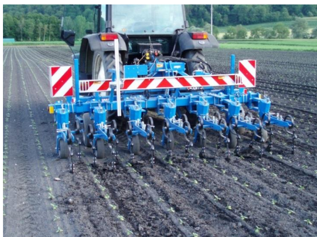
Abb.2a Hackgerät vom Typ Carré mit einer Arbeitsbreite von 3m.
