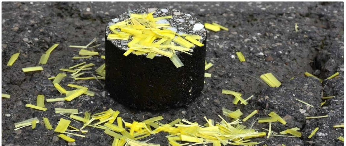
Dreidimensionale Verstärkung der Strasse mit Fasermix aus Aramid und Polyolefin
