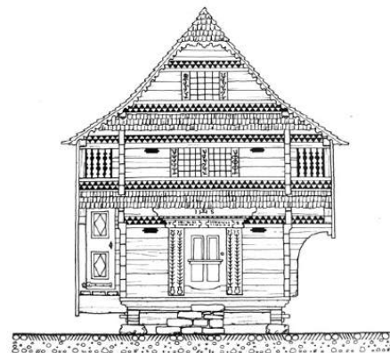
Abb. 32 Lüftungsschlitze links und rechts neben Eingang im EG und dem Doppelfenster im OG am Beispiel des Kornspeichers Hüswil-Grossmatte, datiert 1769. (Brunner 1977, S. 291)
