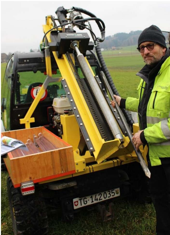
Abbildung 6. Bohrfahrzeug der Firma bodenproben.ch. Mit dem Bohrturm lässt sich sowohl die Bohrhülse für den 36-mm-Bohrkern bedienen (auf dem Bild montiert), wie auch den 18-mm-Stechbohrer (in der Hand des Geschäftsführers von bodenproben.ch). (Foto: KOBO).
