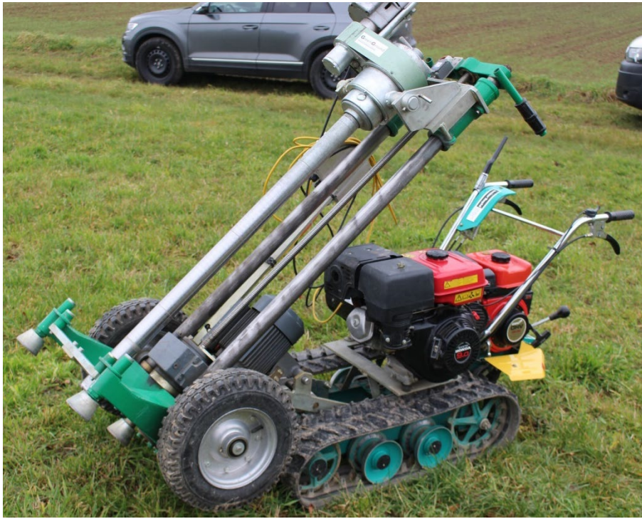
Abbildung 5. Rotations-Kern-Bohrgerät auf kleinem Raupenfahrzeug der Firma GreenGround. Der Bohrturm wird auch auf grösseren Pneu-Trägerfahrzeugen eingesetzt. (Foto: KOBO).
