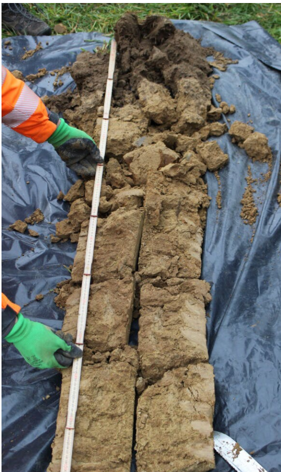
Abbildung 4. Aufgebrochener 145 mm-Bohrkern, bereit zu Erhebung der Bodeneigenschaften. Durch die grosse ungestörte Fläche lassen sich auch Eigenschaften wie Gefügeart und geologisches Ausgangsmaterial relativ gut bestimmen. (Foto: HAFL).
