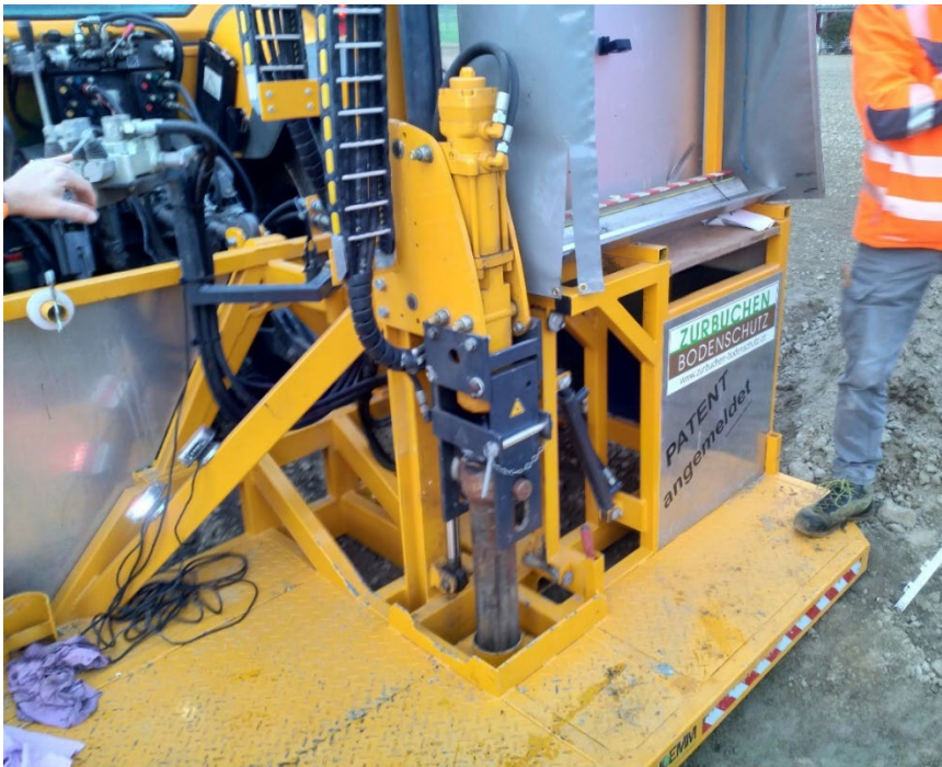
Abbildung 3. Bohrgerät auf landwirtschaftlichem Trägerfahrzeug der Firma Zurbuchen Bodenschutz. Die Bohrhülse gibt es mit einem Innendurchmesser von 145 und 80 mm. (Foto: HAFL)
